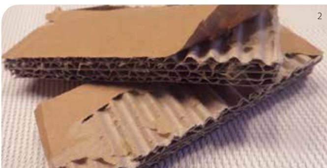
Karton mit gewellter Zwischenlage
