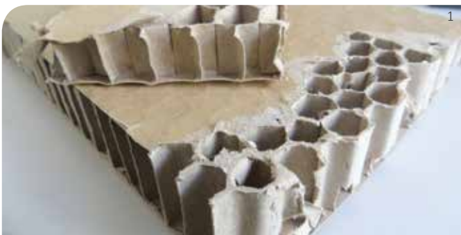
Karton mit Wabenstruktur der Zwischenlage
