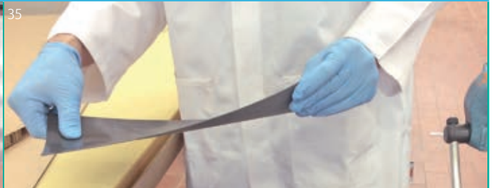
35 Untersuchung auf Torsionssteifigkeit
