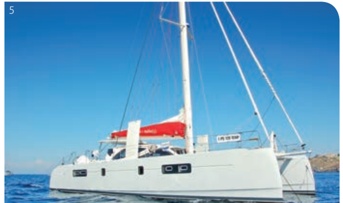
Boots- und Yachtbau – Beispiel für Bauteil aus CFK: Rumpf, Mast
