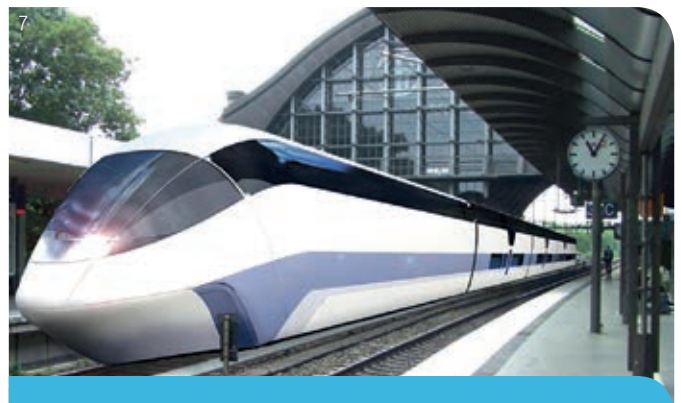
Schienefahrzeuge – Beispiel für Bauteil aus CFK: Triebwagen-Kupplung, Zugarfang/-ende (Zugnasen), Fußboden
