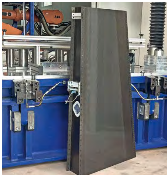
Seitenruder-Ab-schnittsdemonstrator mit thermoplastischen Sandwich-schalen
