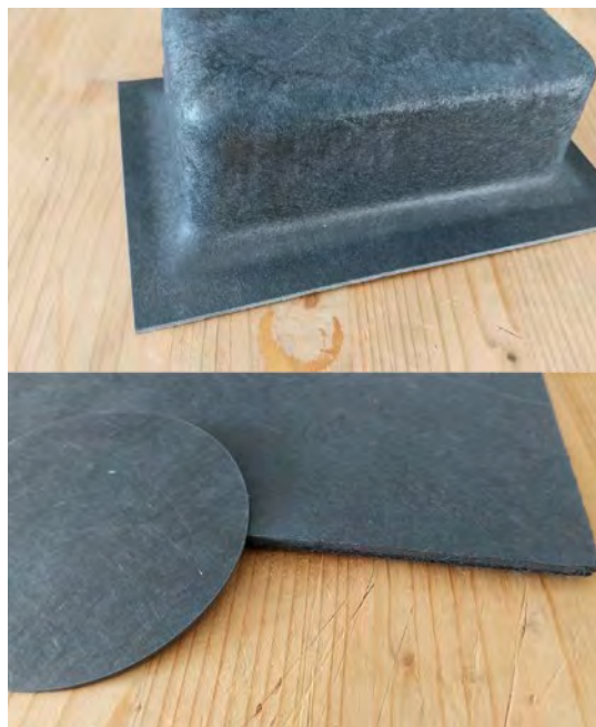
Abb. 2: Platten- und Schalenhalbzeuge der Materialien mit neuartigen Schirm-dämpfungseigenschaften
