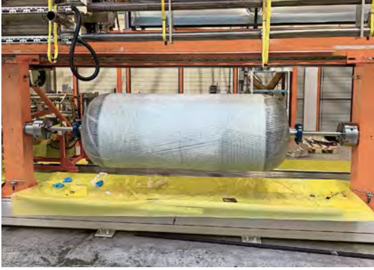
Liner aus PA6 und Boss-Elemente als integrierte Kernstruktur
