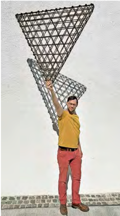
Robotisch gewickeltes Fassadenelement: 1 m 2 aus Hanffaser mit Chitosanmatrix
