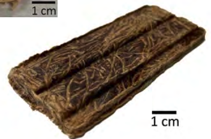
Liquid Deposition Modelling (LDM) – 3D-gedrucktes monolithisches Bauteil aus reinem Myzel: „nass“ nach dem Druck (li.), nach Trocknung (re.)
