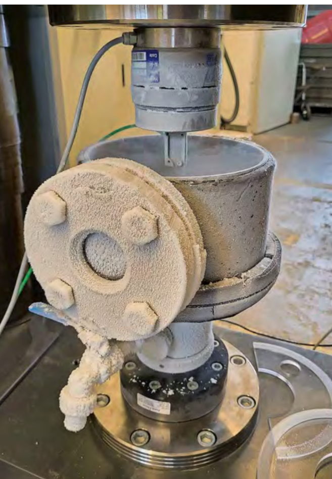
Materialprüfstand zur Ermittlung von mechanischen Kenndaten bei -196^{\circ}\text{C} in flüssigem Stickstoff
