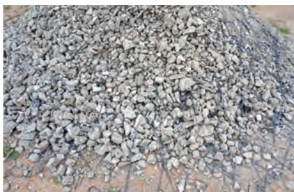
... über zerkleinertes Recyclat aus Beton und Carbonfasern ...
