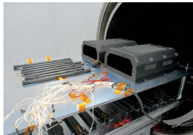
Inspektion der Baseplate für das Instrument auf der Montagevorrichtung
