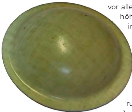
Halbkugel-Demonstrator aus GF/PP, entstanden in Zusammenarbeit mit KVB Forschung
