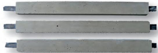
Probekörper mit singularen Towpregs
