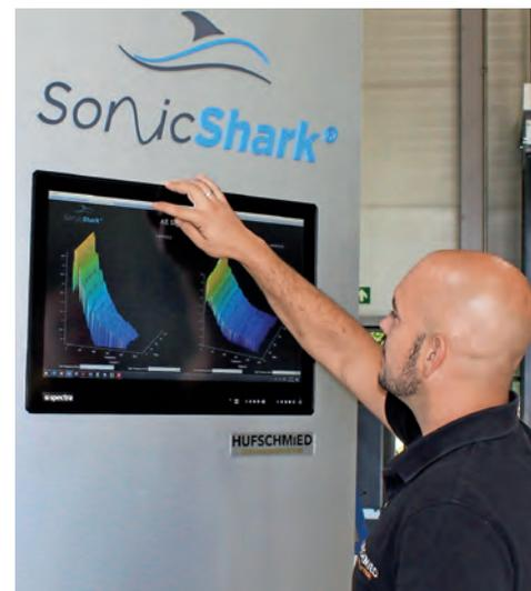
*SonicShark® zeigt den Soll-Ist-Vergleich der Frequenzbänder auf dem Monitor an und visualisiert so „verdächtige Geräusche“ aus der CNC-Maschine*
