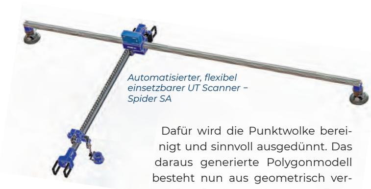
Automatisierter, flexibel einsetzbarer UT Scanner – Spider SA
