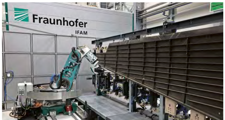
Die neuentwickelte flexible Fräskinematik auf einer Linearachse bearbeitet hochpräzise ein CFK-Flugzeugseitenleitwerk im 1:1-Maßstab
