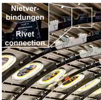
Abb. 1: Flugzeugstruktur, aus verschiedenen Bauteilen über Nietverbindungen gefügt, wobei jede Nietverbindung eine hochpräzise Bohrung erfordert.
