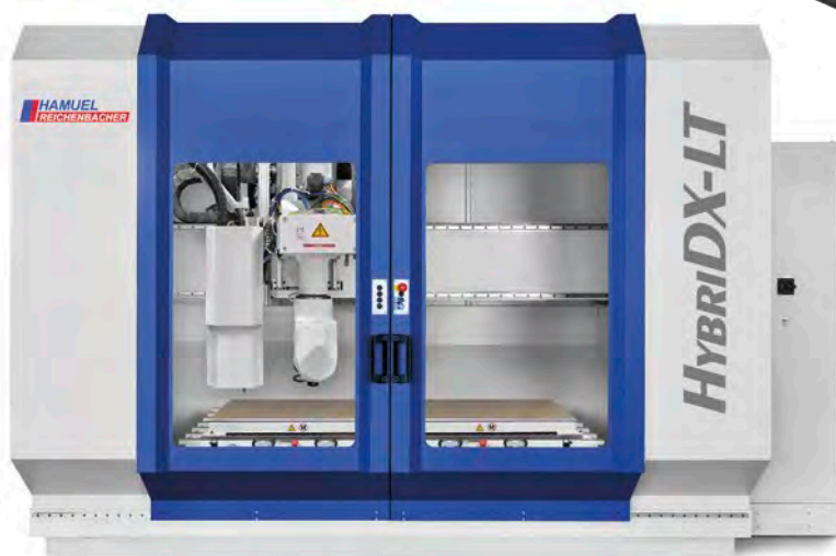
Die HybriDX-LT von Reichenbacher Hamuel kombiniert industriellen 3D-Druck mit präziser 5-Achs-Bearbeitung.
