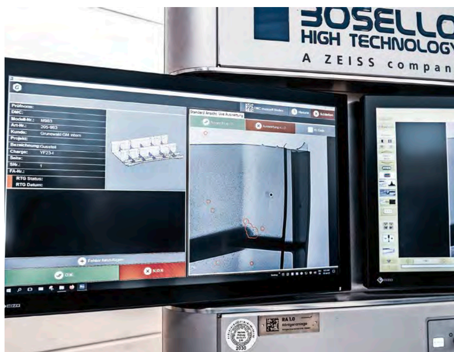
Auf einem Bildschirm der Röntgenanlage markiert die KI potenzielle Fehler
