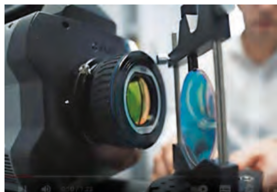
Fehlerdetektion und Qualitätskontrolle (o.) sowie Messung vor Ort (Mitte) mit aktiver Infrarotthermografie (u.)
