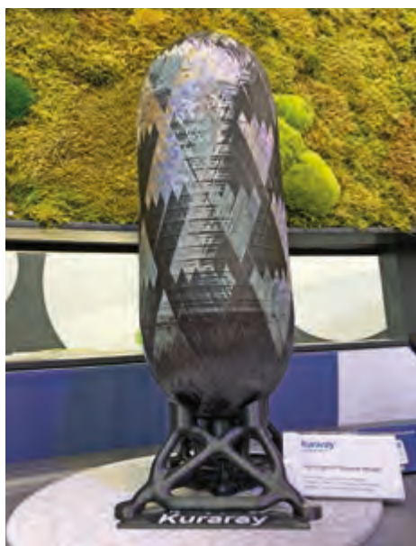
Wasserstoff-Drucktank aus PA9T-impregnierten UD-Tapes
