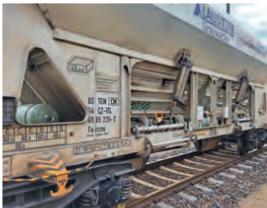
Einbauzustand der Glasfaserdruckbehälter im Güterwaggon
