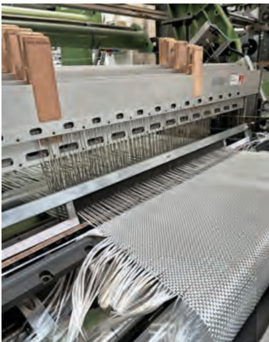
Einbau und Validierung des flexiblen Webblattes
