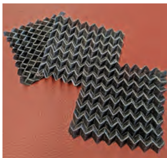
Faltkerne aus recyceltem Carbonfaservlies
