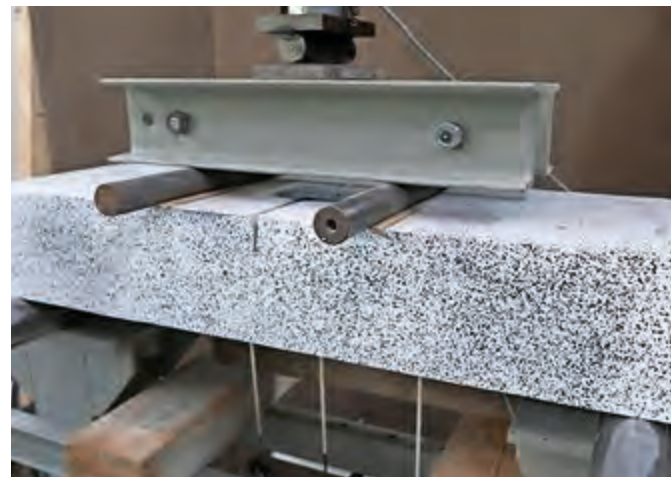
Abb. 3: Auswertung (li.) und Aufbau (o.) und des modifizierten Biegeversuchs nach RILEM RC5 (Spezifikation der Netzgitterträgergeometrie nach Breite – Winkel – Überlappung im Zugstrang bspw. 300mm – 60° – 4 Rovings)
