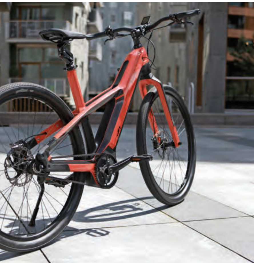
Buddy sX1 Thermoplast-Verbund-Rahmen – strukturmechanisch ausgelegt vom LZS Buddy sX1 thermoplastic composite bike frame – structurally designed by LZS
