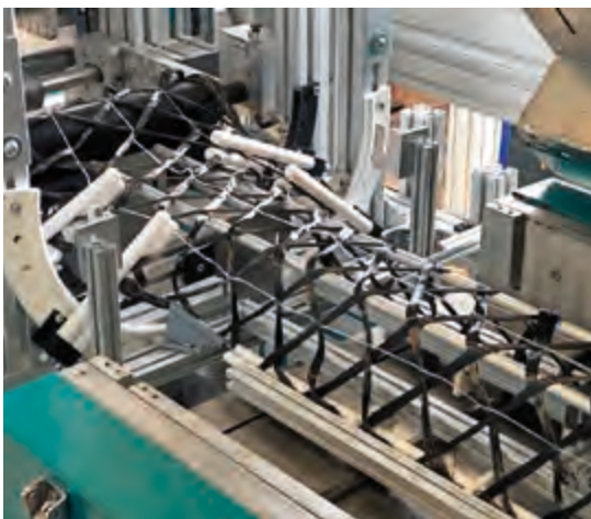
Abb. 2: Entwicklung einer erweiterten Kettfadenversatztechnologie (re.) und neuartigen Umformeinrichtung (li.) zur Fertigung von 3D-Netzgitterträgern
