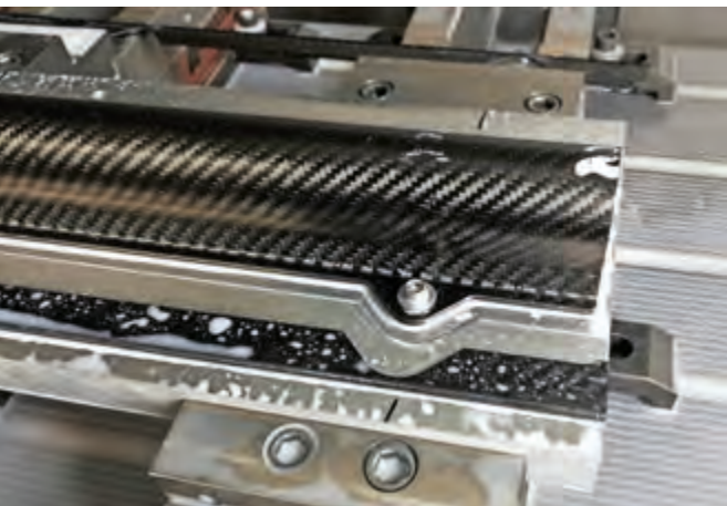
Fertigung CFK-Gehäuse mit Nachbearbeitung
