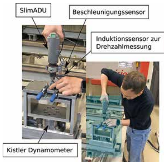
Versuchsstand für Bohruntersuchungen mit Handbohrmaschine SlimADU
