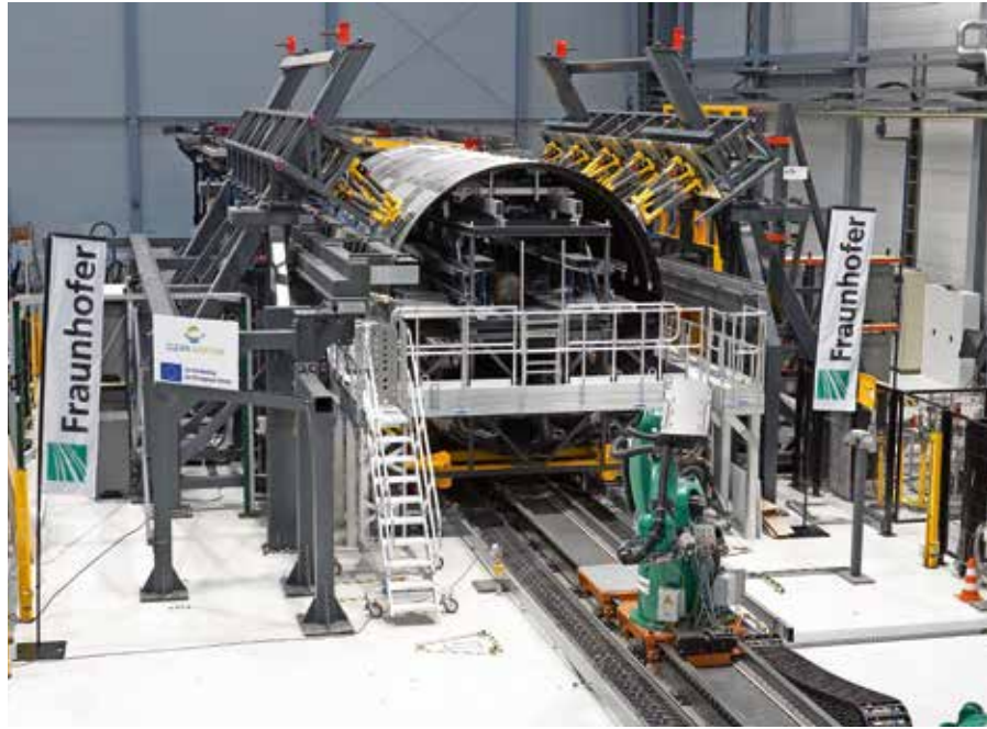
MFFD-Montage-Forschungsplattform mit integrierten thermoplastischen Rumpfschalen bei Fraunhofer, Stade
