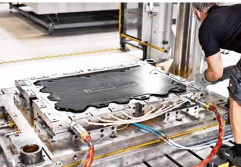
Herstellung der Asglaplatte, einer leichten, gleichwohl höchst belastbaren Bodenplatte
