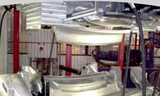
Automatisiertes RTM-Werkzeug mit Schiebertechnologie
