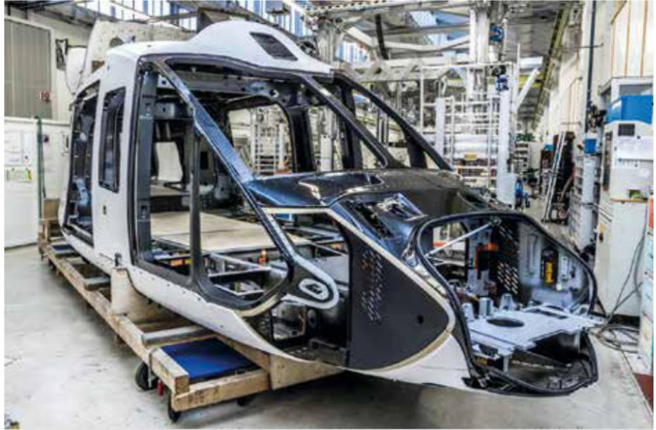
*Dank kontinuierlicher Verbesserung der CFK-Fertigungsverfahren besteht die Zelle der H160 etwa zu drei Viertel aus Carbon.*
