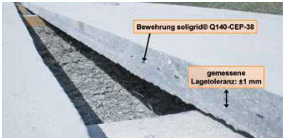
Bild 2: Aufgeschnittene Fassadenplatte zur Überprüfung der Lagetoleranz
