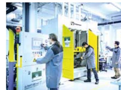
RTM-Prozess mit Injektionsanlage, Werkzeug und Schließeinheit.
