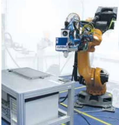
Abb. 4: Mobiles Schweißmodul, auf Roboter montiert
