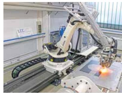
Abb. 2: AFP-Anlage für duroplastische Matrixmaterialien
