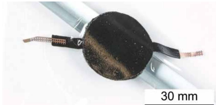
Vollpolymerer dielektrischer Elastomeraktor mit einem Elektroden Durchmesser von 30 mm, bestehend aus einer transparenten dielektrischen Schicht, die beidseitig mit dem identischen, elektrisch modifizierten Basis-Polymer beschichtet ist, inkl. der Leiterbahnen zur Fixierung der externen Kontaktierung. Entwickelt im BMBF-geförderten Projekt „Compositbasierte neue dielektrische Elastomer Aktoren (Candela)“.
