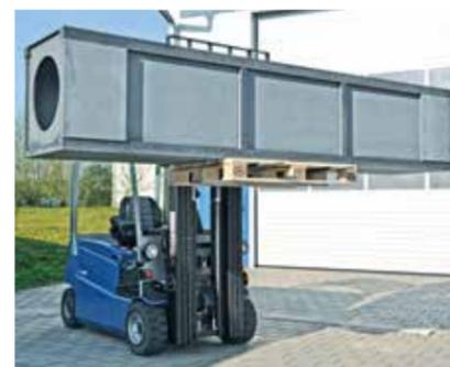
*CFK-Grundkörper der y-Achse einer Laserschneidmaschine*
