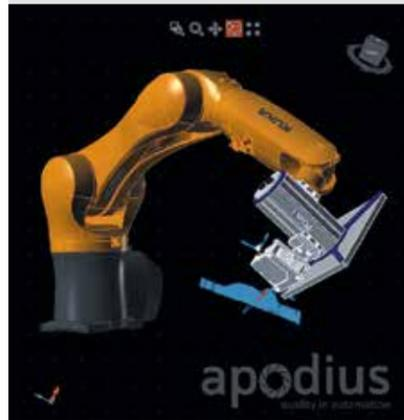
Die AVS-Software bietet gleichzeitige Echtzeit-Virtualisierung des Messvorgangs und den Soll-Ist-Vergleich der aufgenommenen und angezeigten Ist-Geometrie mit den hinterlegten CAD-Daten.
