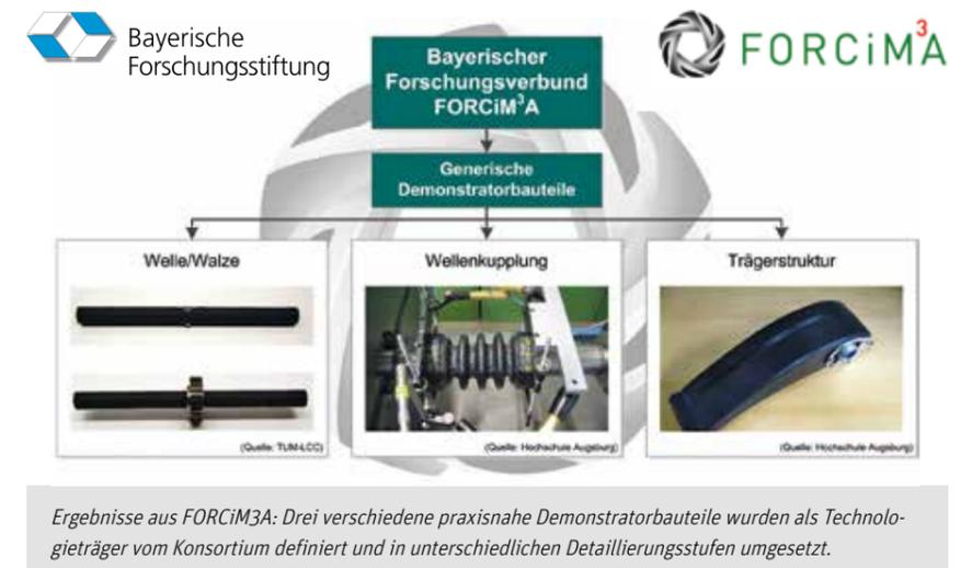
Prozesstechnologien und Prüfwerkzeuge für faserverbundene Werkstoffe und materialhybride Strukturen im Maschinen- und Anlagenbau geschaffen. Dabei handelt es sich um eine „Welle/Walze“, z.B. zum Einsatz in der Antriebstechnik/Papierherstellung, eine „Wellenkupplung“, z.B. für Anwendungen in der Antriebstechnik, und eine „Trägerstruktur“, z.B. für den Bereich der (Lebensmittel-)Verpackungsindustrie.
