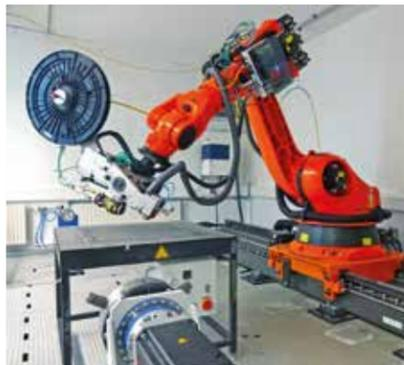
Abb. 1: AFP-Anlage mit Laserheizeinheit für thermoplastische Matrixmaterialien
