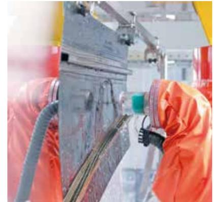
Roboterassistierte zerstörungsfreie Prüfung an CFK-Karosserie
