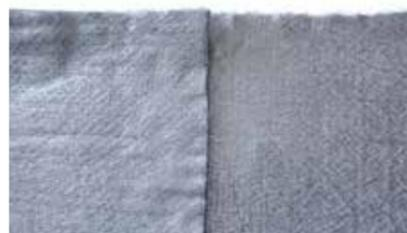
Vergleich vernadelter Vliesstoff (l.) und wasserstrahlverfestigter Vliesstoff (r.) beide bestehend aus 100 Prozent rCF
