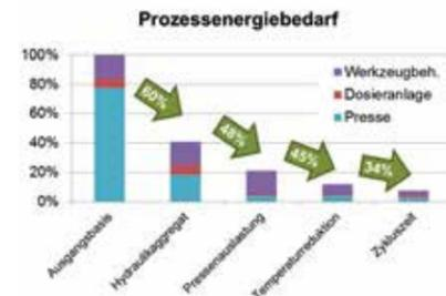
Abb. 2: Energieeffiziente Prozessführung am Beispiel RTM-Prozess
