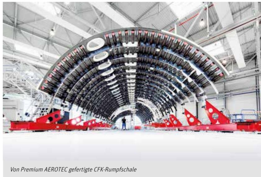
Von Premium AEROTEC gefertigte CFK-Rumpfschale
