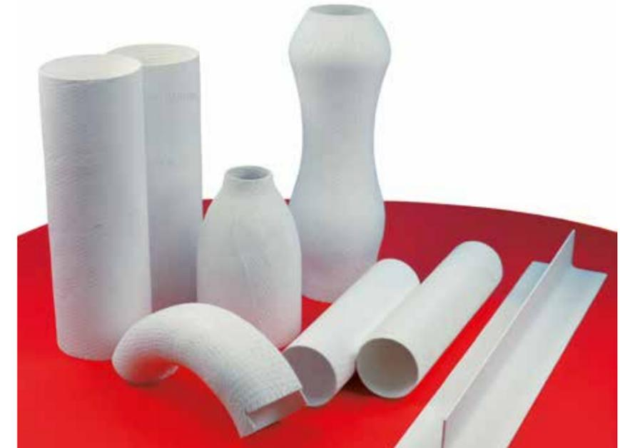
Oxidkeramische Verbundwerkstoffe, hergestellt über die Prepreg-Route. Die Composites bestehen aus  $Al_2O_3$ -Fasern und  $Al_2O_3$ - $ZrO_2$ -Matrices.
