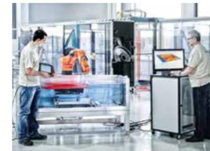
Roboterassistierte Ultraschall-Prüfung mit integrierter 3D-Rekonstruktion des Bauteilvolumens
