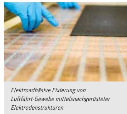
Elektroadhäsive Fixierung von Luftfahrt-Gewebe mittels nachgerüsteter Elektrodenstrukturen
