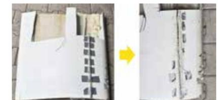
Abb. 2: Rotorblattbauteil mit applizierter Sprengschnur vor (l.) und nach (r.) der Zündung
