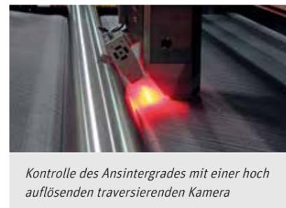
Kontrolle des Ansintergrades mit einer hochauflösenden transversierenden Kamera
