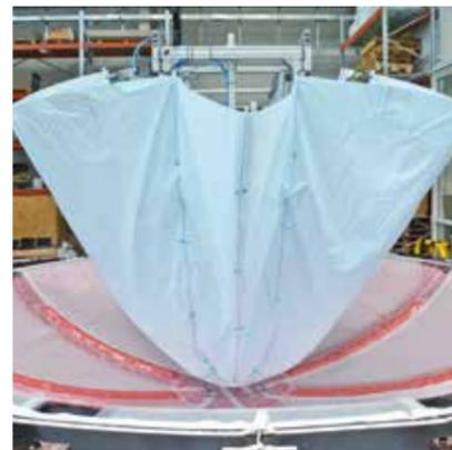
Alle textilen Materiallagen des VAP®-Aufbaus für die Druckkalotte des A350 wurden im Projekt RoCK in einem VAP®-3D-Kit bauteilorientiert konfektioniert und automatisiert abgelegt.
