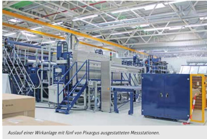
Auslauf einer Wirkanlage mit fünf von Pixargus ausgestatteten Messstationen.
