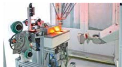
Abb. 3: Fiber Patch Placement Anlage
