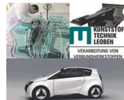
Fertigung einer PKW-Bodengruppe im Harzinfusionsverfahren (Projekt CULT)
