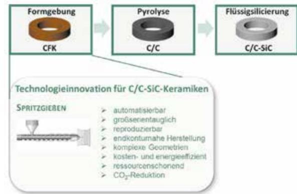
Abb. 1: Schematische Darstellung zur großserientauglichen Herstellung von C/C-SiC-Keramiken über den Spritzgießprozess und dessen Vorteile.
