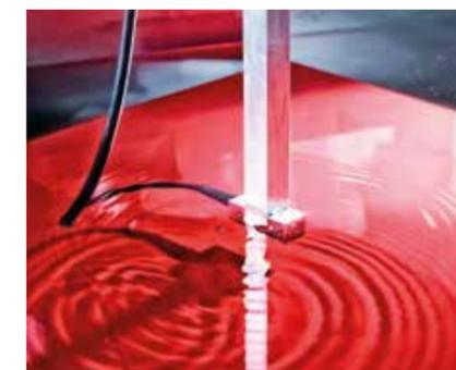
Sensor für die zerstörungsfreie Prüfung von CFK-Komponenten
