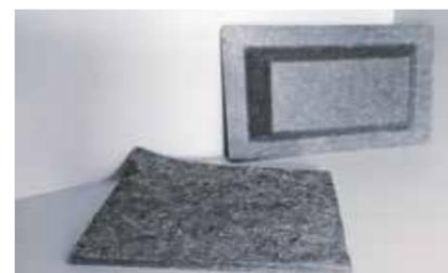
Vliesstoff aus Carbonfasern, Naturfasern und Polypropylen sowie daraus hergestelltes Formteil
