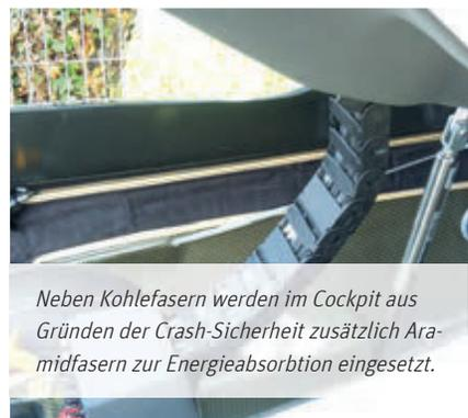
Neben Kohlefasern werden im Cockpit aus Gründen der Crash-Sicherheit zusätzlich Aramidfasern zur Energieabsorption eingesetzt.
