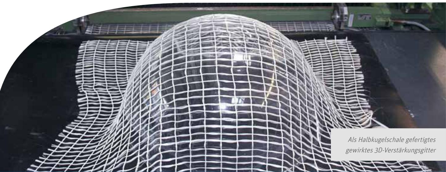
Als Halbkugelschale gefertigtes gewirktes 3D-Verstärkungsgitter
