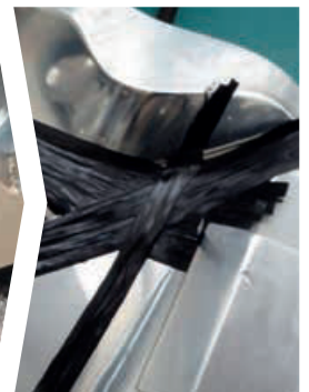
Lastpfadgerechtes Platzieren der vorkonfektionierten Tapes Load path appropriate positioning of the pre-fabricated tapes
