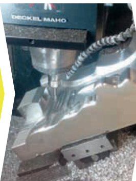
Fräsen des Femis auf der schuleigenen 5-Achs-Fräsmaschine Milling of the Femis on the in-school 5-axis milling machine
