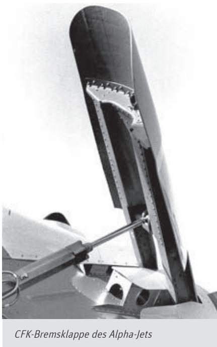
CFK-Bremsklappe des Alpha-Jets
