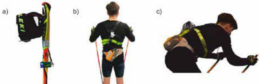
Einsatzbereites Monitoringsystem (a), Rückansicht des Sportlers mit Elektronikmodul im Trinkgurt (b) und Sportler auf dem Laufband des IAT (c)
