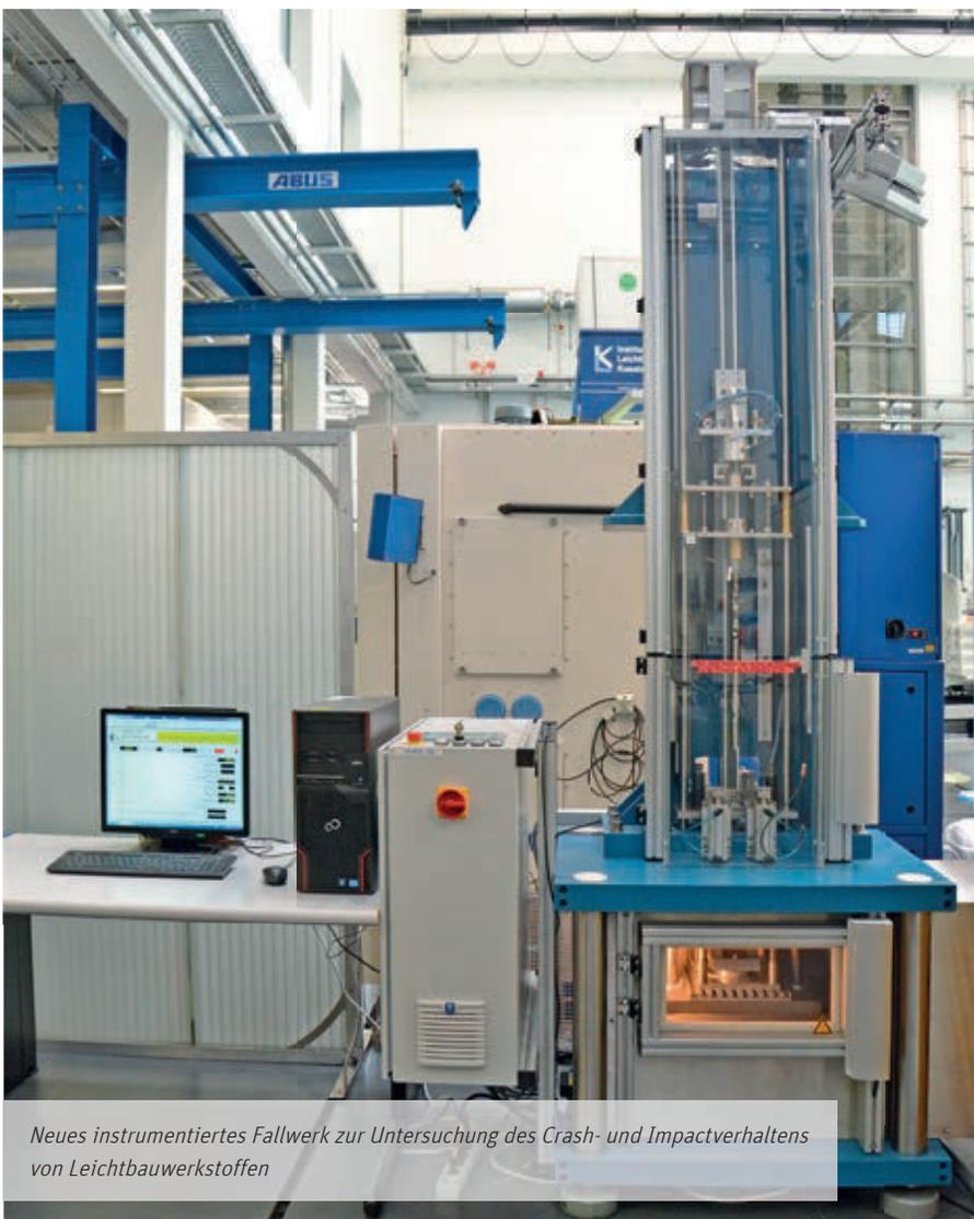
Neues instrumentiertes Fallwerk zur Untersuchung des Crash- und Impactverhaltens von Leichtbauwerkstoffen
