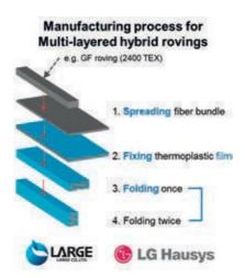
red Hybrid Mat (MLH-Mat) Fasermatten eingesetzt werden. Durch den mehrlagigen Aufbau im Filmstackingverfahren können für PP/GF Faservolumenanteile von bis zu 45 Vol.-Prozent im Bauteil realisiert werden. Die Verarbeitung erfolgt ähnlich dem Standard GMT-Verfahren. Mittels einer gezielten und lastgerechten Verstärkung von MLH-Matten mit MLH-Rovings eignen sich diese Materialien insbesondere auch für den Einsatz in strukturell stärker beanspruchten Bauteilen.
