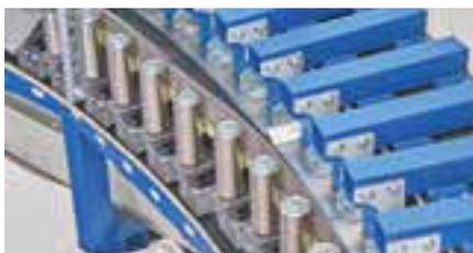
Preform-Anlage: Detail der Aktuatorik
