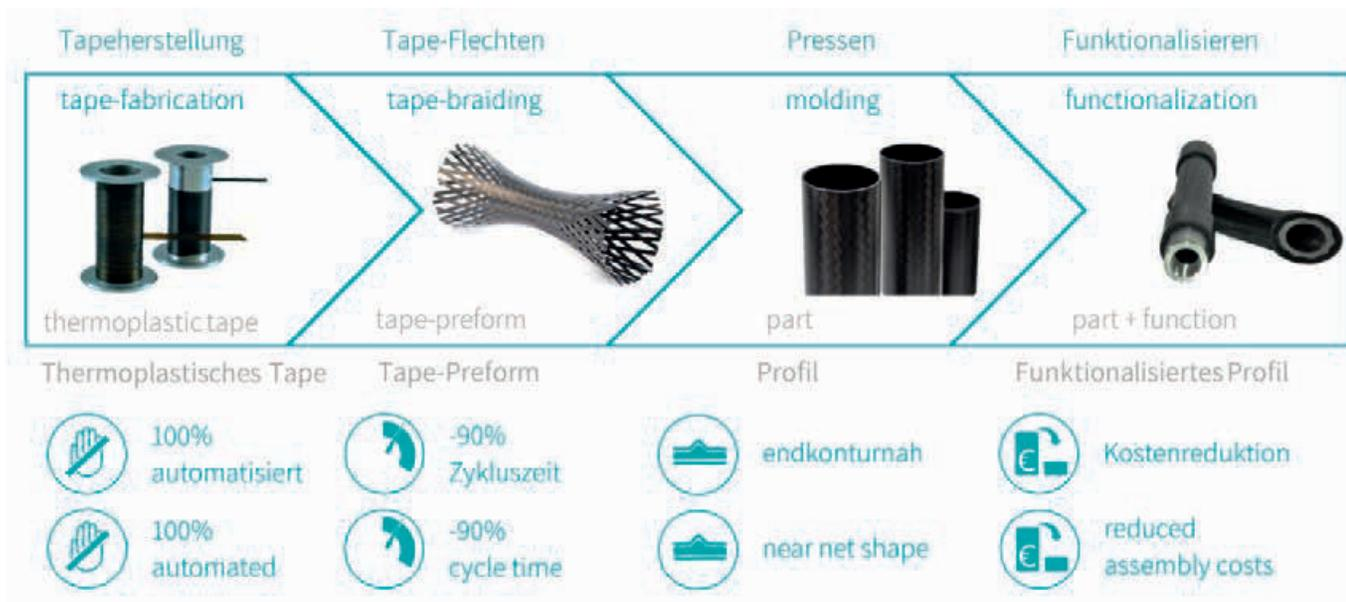
*Herone Technologie für die Herstellung thermoplastischer Faserverbund-Profile
