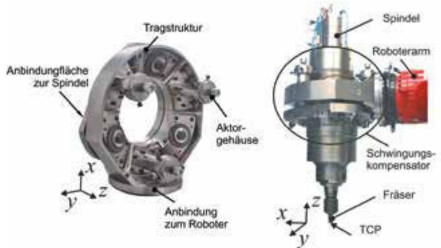
Links: Industrieroboter mit prototypischem Schwingungskompensator ohne Antriebsspindel
