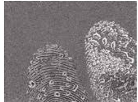
*Detektion von Fingerabdrücken auf CFK-Oberflächen mittels Aerosol-Benetzungsprüfung*
