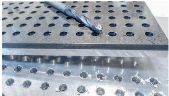
*Bohrwerkzeuge zur Bearbeitung von Stack-Werkstoffen
