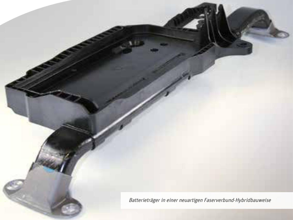
Batterieträger in einer neuartigen Faserverbund-Hybridbauweise
