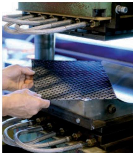
*Einlegen eines Tixpref-Gewebes in eine einfache Pressform*
