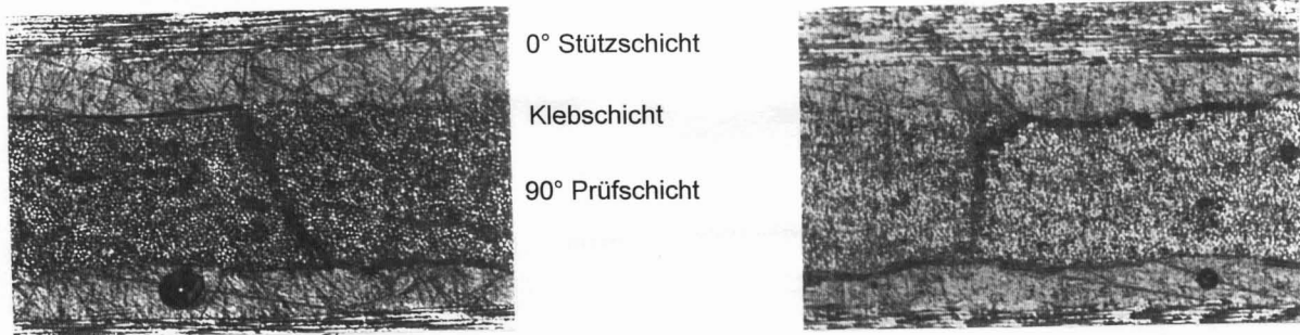
Bild 10/10: Rißbildung für ( \sigma_2=0 , \tau_{23} ) beim kalt verklebten Verbundbiegebalken
