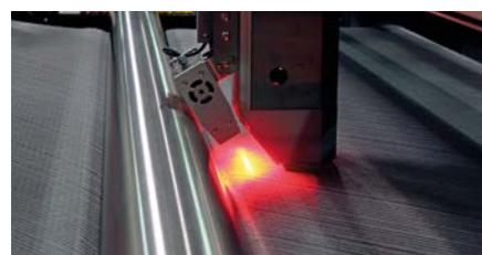
*Kontrolle des Ansintergrades mit einer hoch auflösenden traversierenden Kamera*
