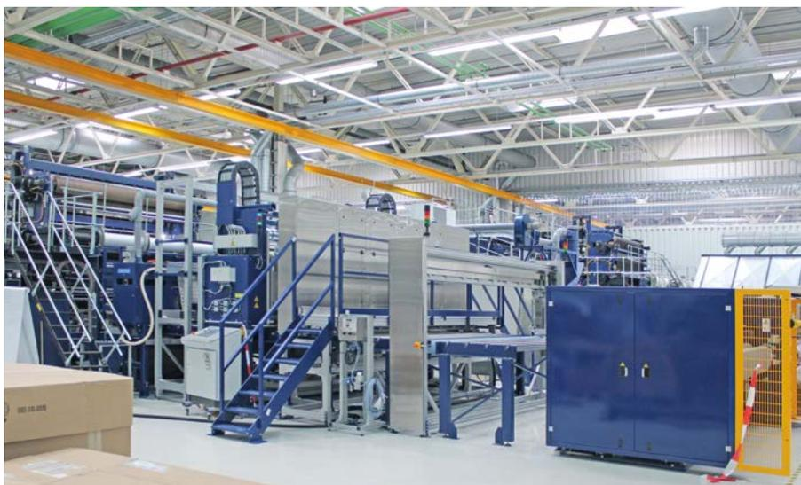
*Auslauf einer Wirkanlage mit fünf von Pixargus ausgestatteten Messstationen.*
