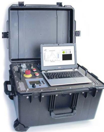
Abb. 2: Mobiler Reparaturkoffer zur Erzeugung des benötigten Prozessdrucks und der Temperatur
