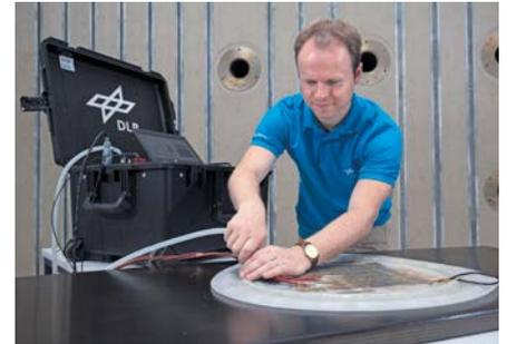
Abb. 3: Anwendungsbeispiel des mobilen Reparaturkoffers
