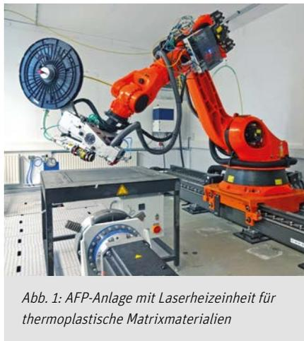
Abb. 1: AFP-Anlage mit Laserheizeinheit für thermoplastische Matrixmaterialien
