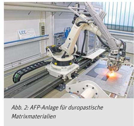
Abb. 2: AFP-Anlage für duroplastische Matrixmaterialien
