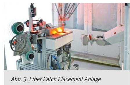
Abb. 3: Fiber Patch Placement Anlage
