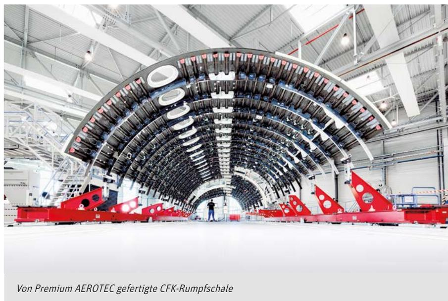
Von Premium AEROTEC gefertigte CFK-Rumpfschale
