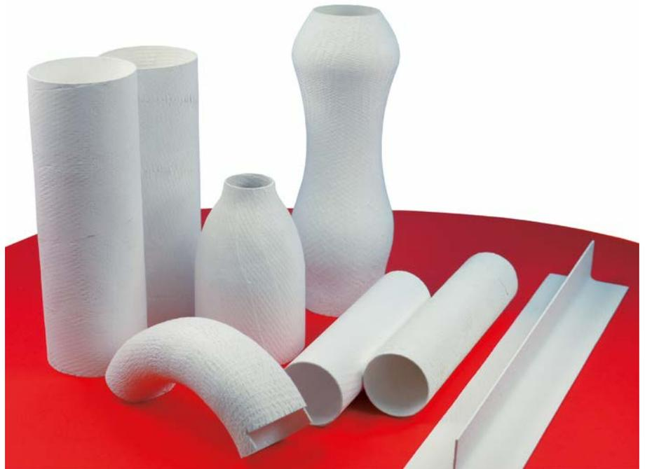
*Oxidkeramische Verbundwerkstoffe, hergestellt über die Prepreg-Route. Die Composites bestehen aus  $\text{Al}_2\text{O}_3$ -Fasern und  $\text{Al}_2\text{O}_3$ - $\text{ZrO}_2$ -Matrices.*
