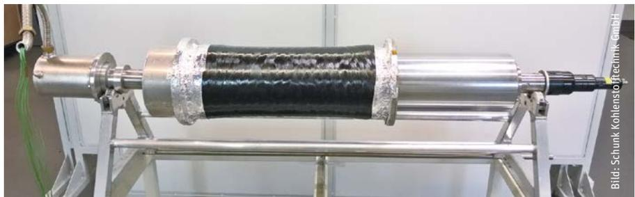
Wickelkörper mit Rotationsvorrichtung für die Mikrowellenaushärtung (Bauteil von Schunk Kohlenstofftechnik GmbH)
