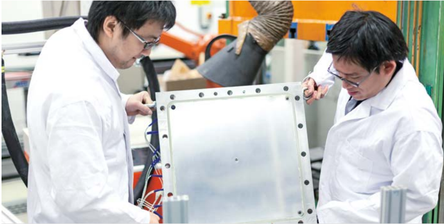
Abb. 4: Kollegiaten bei der Herstellung einer Hybridstruktur mittels eines angepassten Resin Transfer Moulding Prozesses (Foto: Jan Olaf Scholz)
